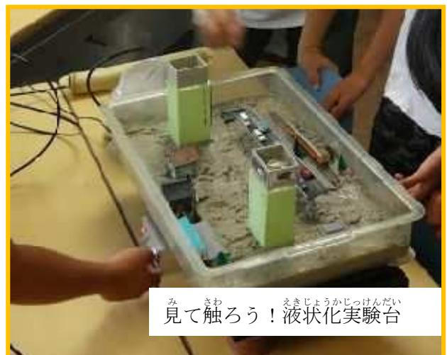
み さわ 見て触ろう！液状化実験台
